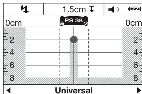
В сензорния диапазон се намира метален, токопроводящ обект, напр. електрически кабел. Приблизителната дълбочина възлиза на 1,5 см (0.6 инча). Уредът изпраща предупредителния сигнал за тоководещи проводници, щом електрическият кабел бъде разпознат от сензора.
