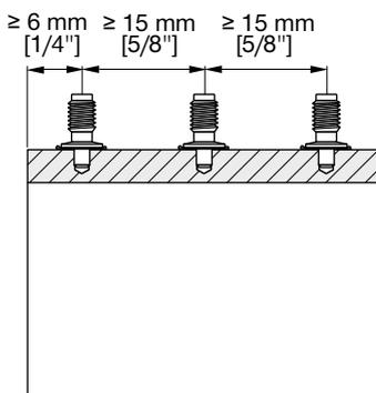
Edge distance:  $\geq 6 \text{ mm}$
