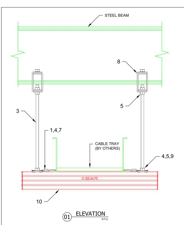
TRAPEZE STYLE CABLE TRAY SUPPORTED FROM STEEL BEAM FLANGE WIDTH 3/4" OR SMALLER (T4B & T4BHD)
