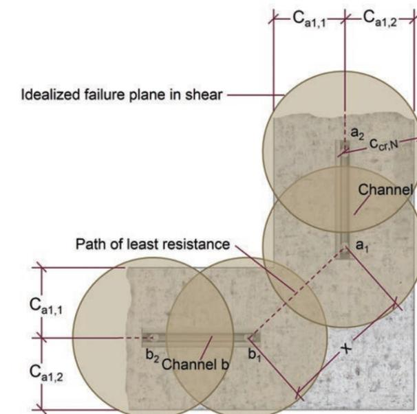
Figure 9.2.12.1-a — Inside Corner — Tension.
