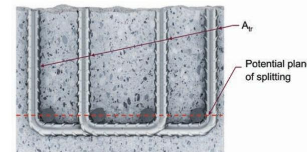
Figure 8.2.1.4 — Transverse reinforcement ( $A_{tr}$ ).
