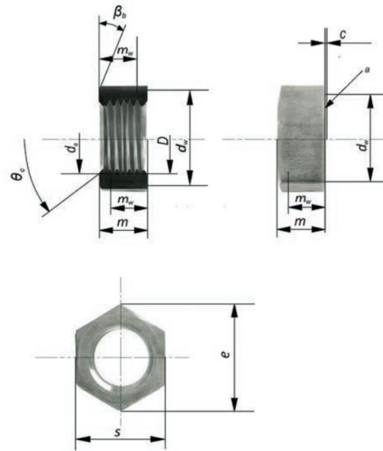
Figure 2.2.12.2 — HBC-C and HBC-C-N nut dimensions.
