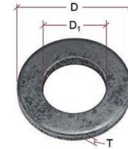
Figure 2.2.12.3 — HBC-C and HBC-C-N washer dimensions.
