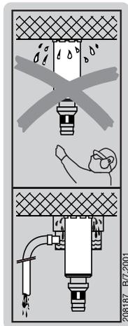
天井への施工時には、湿式バキュームクリーナーに接続した水処理システムを必ず使用してください。
